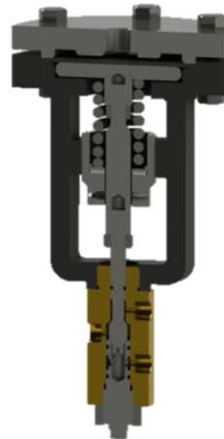
Fig. 2: Imagem em corte Piloto controlador
